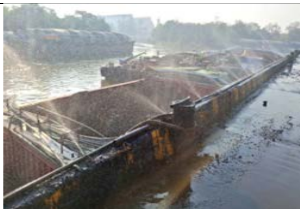
การตรวจสอบระบบสปริงน้ำ (ไม่แตกหัก/ชำรุด)
