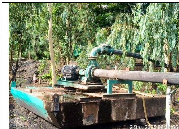
รูปที่ 2.2-45 เครื่องสูบน้ำในบ่อดักตะกอน 2
