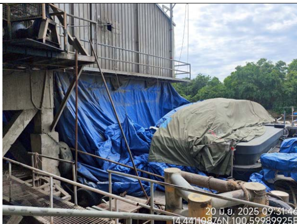
รูปที่ 2.2-22 ผ้าใบคลุมโครงกลองสินค้าขณะขนถ่ายปูนเม็ดลงเรือลำเลียง
